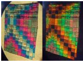
Biréfringence du scotch (lumière blanche) Couleurs complémentaires 2 polariseurs // (à gauche) ou \perp (à droite).
